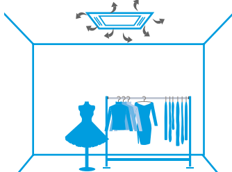
Rozkład powietrza z zabrudzonym filtrem
