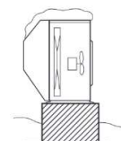
Z zamontowanymi kanałami zabezpieczającymi przed śniegiem (Wysoki podest)
